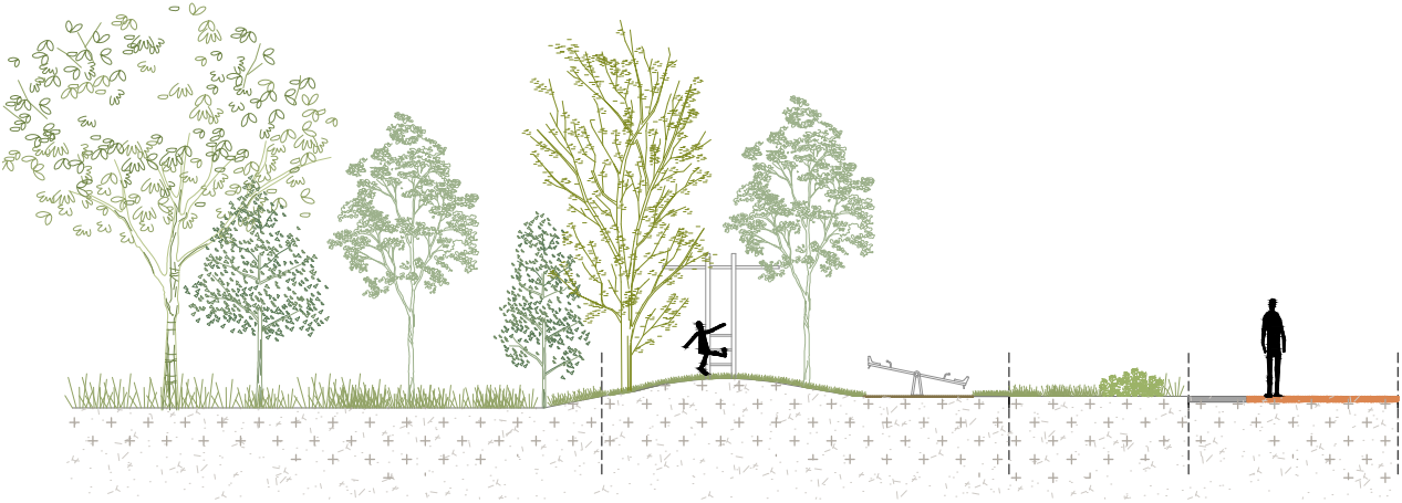
povrchový vsak - trávnik + meliorační zeleň funkční plocha - trávnik + lokální dopadová plocha oddělovací zelený pás komunikace - žulová přídlažba + mlát
