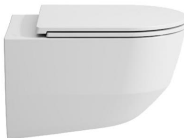
závěsné WC Laufen PRO kapotované, oplach 3/4,5 l provedení Rimless (systém bez oplachového kruhu pro snadnější údržbu)
